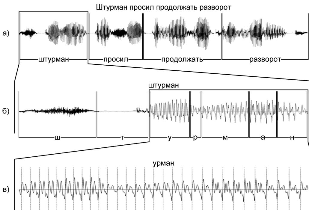
**Рис. 1.15. Пример многоуровневой сегментации речевого сигнала:
