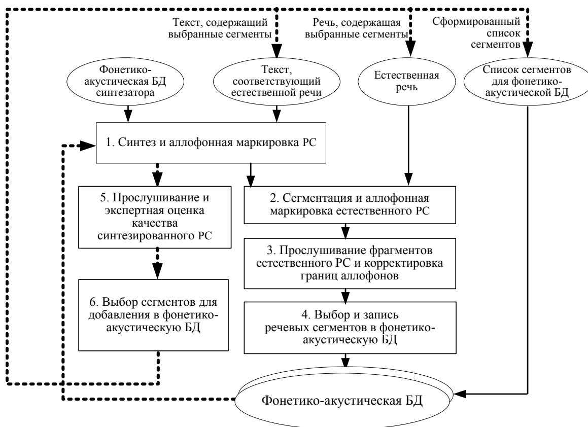
Рис. 2. Общая функциональная схема автоматизированной системы клонирования
