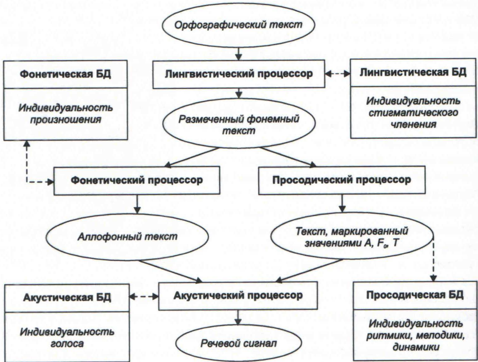
Структурная схема синтезатора персонализированной речи, на базе которого осуществляется клонирование
