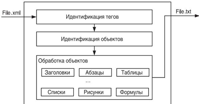
Рис. 3. Схема обработки xml-документа с использованием SAX
