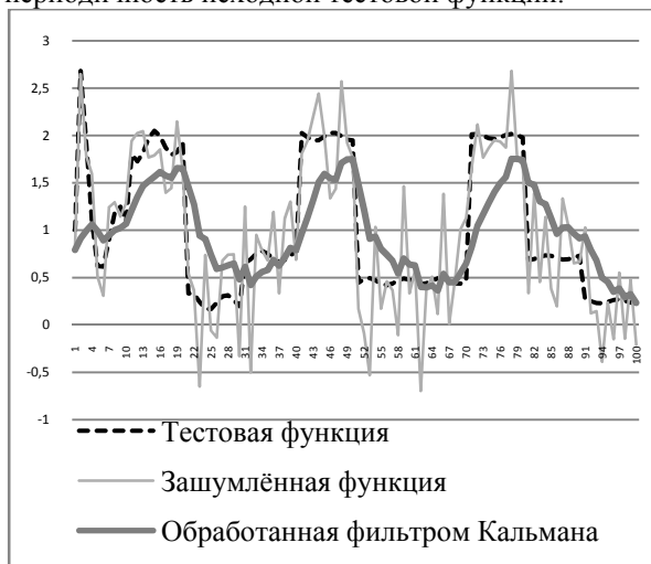
Рисунок 3 - Результаты тестирования фильтра Кальмана сгенератором шума с дисперсией 0.5
